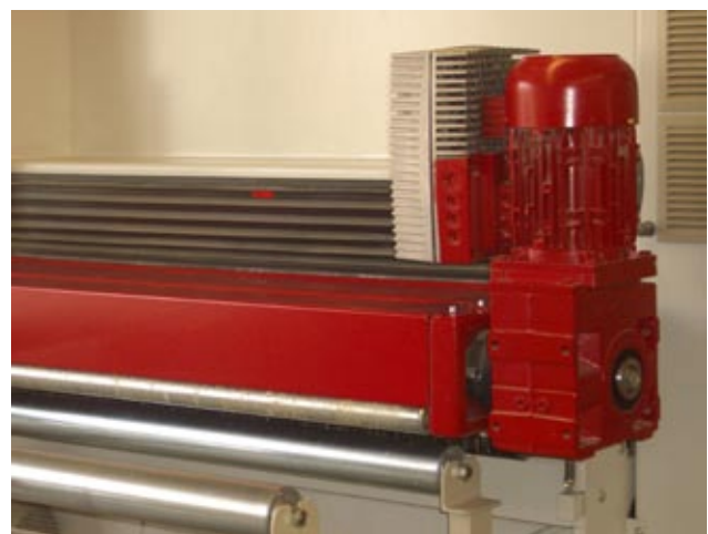
Rollenbahn mit Drehstrom-Asynchronmotor und Frequenzumrichter.
